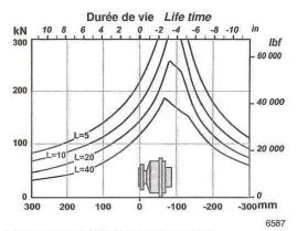
L Millions de tours B10 à 150 bar (pression moyenne), avec fluide HV46 à 50°C, cylindrée Code 0, sans charge axiale. L Million rev. B10 @ 150 bar [2 175 PSI] (equivalent pressure) with HV46 hydraulic fluid @ 50°C [122°F], displac. code 0, no axial load.
