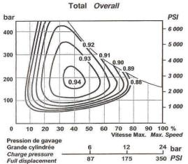
Valeurs moyennes données à titre indicatif pour la cylindrée code 0, 0465 après 100 heures d'utilisation avec du fluide hydraulique HV46 à 50°C.
