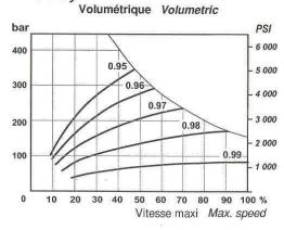
Valeurs moyennes données à titre indicatif pour la cylindrée code 0, après 100 heures d'utilisation avec du fluide hydraulique HV46 à 50°C.
